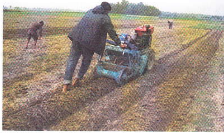
IRRI CIMMYT ও বার্ড কর্তৃক যৌথভাবে বস্তবায়িত Sustainable Intensification of Maize Production System প্রকল্পের আওতায় জমিতে বেড তৈরীর জন্য বেড প্র্যানার ব্যবহার হচ্ছে
